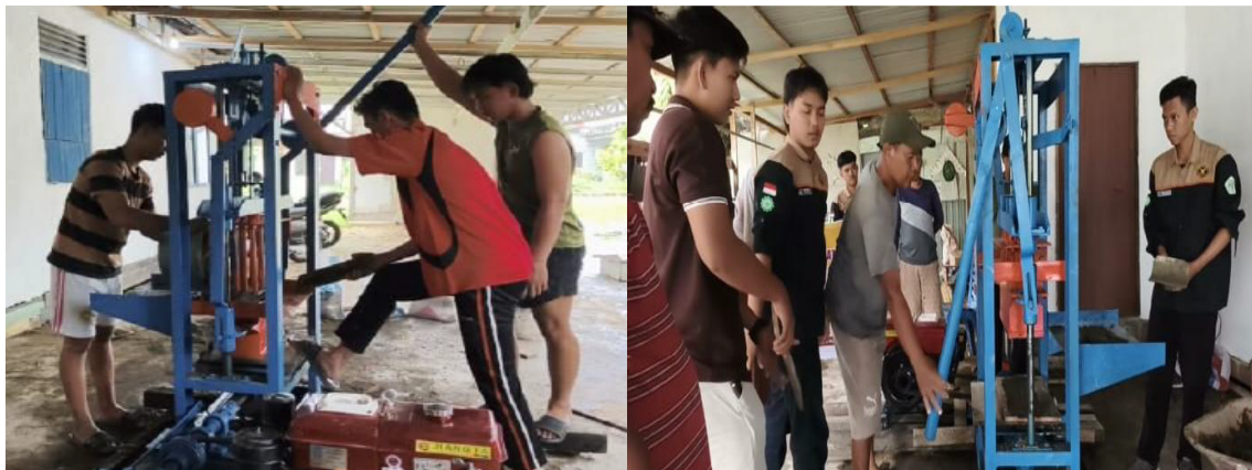
Gambar 4. 7 Pemanfaatan Fly Ash & Bottom Ash untuk Paving Block ECOFABA
